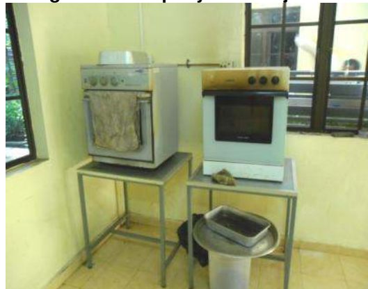
Gambar 2.9 Keadaan Ketuhar Elektrik Yang Tidak Mempunyai Penunjuk Suhu
